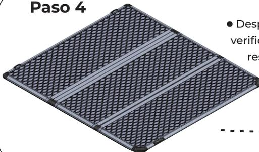
• Desplegar la tercera falange (lado compuerta), verificar posición, ajustar topes laterales con su respectiva herramienta (Llave Torx T40) y luego ajuste con sus cierres.
